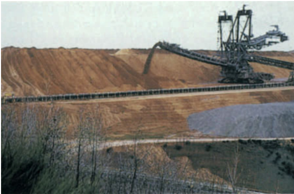
Abb. 3. Forstkiesauftrag mit Großabsetzer (Photo: Rheinbraun)
