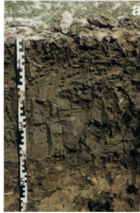
Abb. 1. a Mit LKW geringmächtig aufgeschütteter und planierter Geschiebemergel über kiesigem, lehmigem Sand im 1. Rekultivierungsjahr nach flacher Bodenbearbeitung und Getreidesaat. b Starke Verdichtungen
