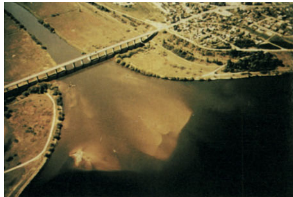
Abb. 2. Einlauf der Mulde in den ehemaligen Tagebau Muldenstein. Geschiebe und Schwebstoffe sedimentieren. Im Stausee bildet sich autochthon Plankton
