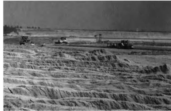
Abb. 2. Mit Großabsetzer angekippte Lößrippen (Photo: Rheinbraun)
