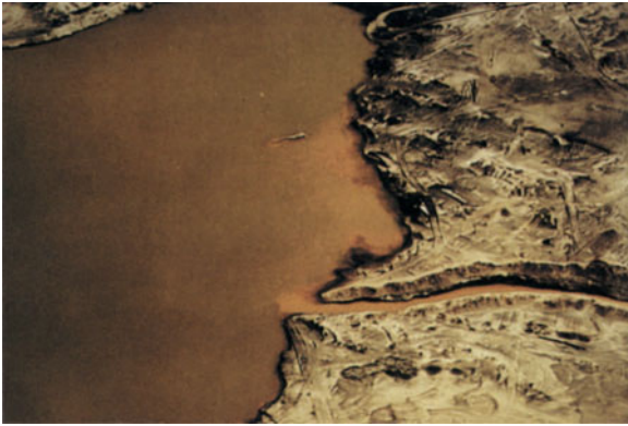
Abb. 4. Im Tagebau Goitsche aufkommendes Grundwasser ist schwefelsauer und enthält bis zu 1500 mg/l Eisen
