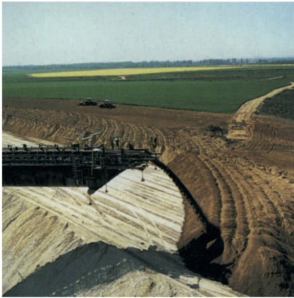
Abb. 1. Gleichmäßiges Absetzen des Bodenmaterials vermindert den späteren Planieraufwand (Photo: Rheinbraun)
