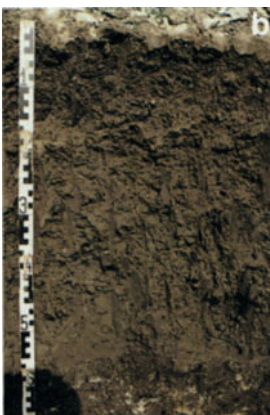
Abb. 1. a Mit LKW geringmächtig aufgeschütteter und planierter Geschiebemergel über kiesigem, lehmigem Sand im 1. Rekultivierungsjahr nach flacher Bodenbearbeitung und Getreidesaat. b Starke Verdichtungen
