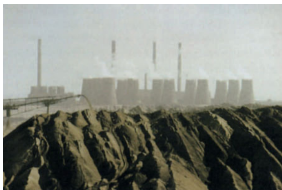
Abb. 10. Schüttung der Förderbrückenkippe Tagebau Nochten im Südläusitzer Urstromtal. Im Hintergrund das Kraftwerk Boxberg
