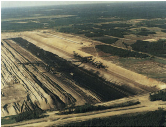
Abb. 1. Förderbrückentagebau Reichwalde. Um das Kohleflöz zugänglich zu machen, muß im Tagebau das Deckgebirge umgeschichtet werden. (Photo: Luftbild Heye)
