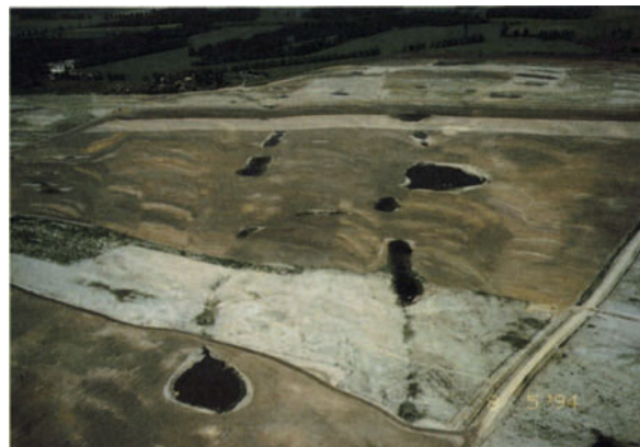
Abb. 4. Lokale Setzungen, insbesondere entlang des Ansatzes eines neuen Kippdurchganges aber auch zwischen einzelnen Rippen, füllen sich schnell mit Wasser. Der Verlauf eines künftigen Fließgewässers deutet sich an (Absetzerkippe Tagebau Greifenhain 1994). (Photo: Möckel)
