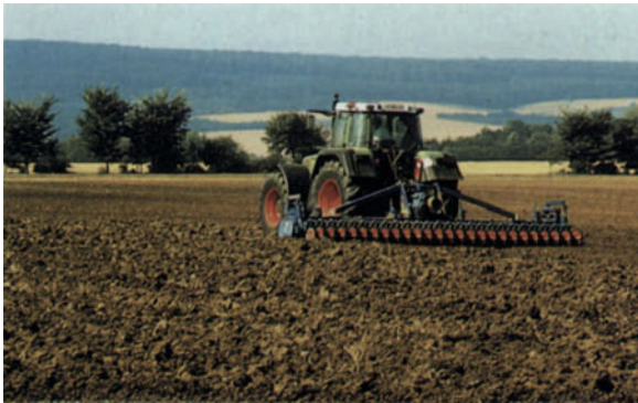
Abb. 1. Saatbeetherrichtung mit Kreiselegge
