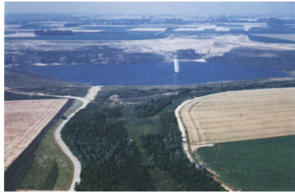
Abb. 4. Rekultivierung im Tagebaubereich Zukunft-West: Befüllung der Blaustein-Seemulde mit hergestellter Seemulde – Aufnahme zum Zeitpunkt der Befüllung. (Photo: Rheinbraun)
