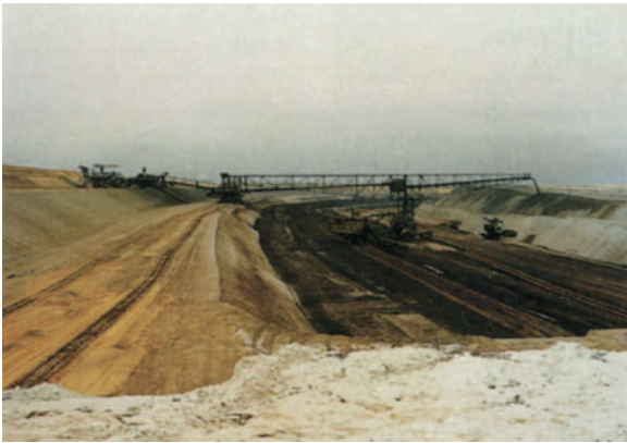
Abb. 4. Abraumförderbrückenbetrieb (Tagebau Espenhain, 1993)
