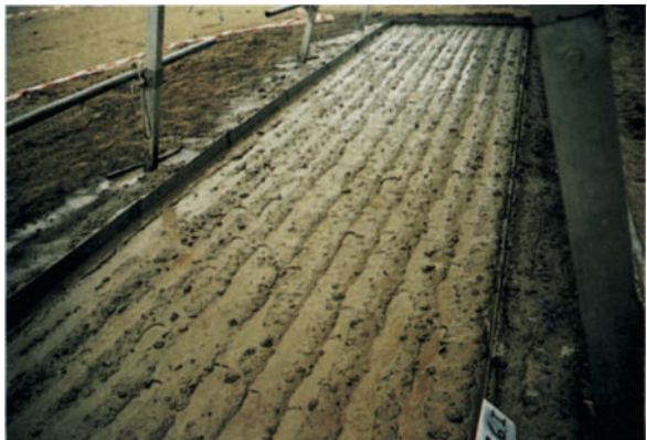
Abb. 2. Meßparzelle auf der Altlandfläche Bourheim während der 1. Beregnung
