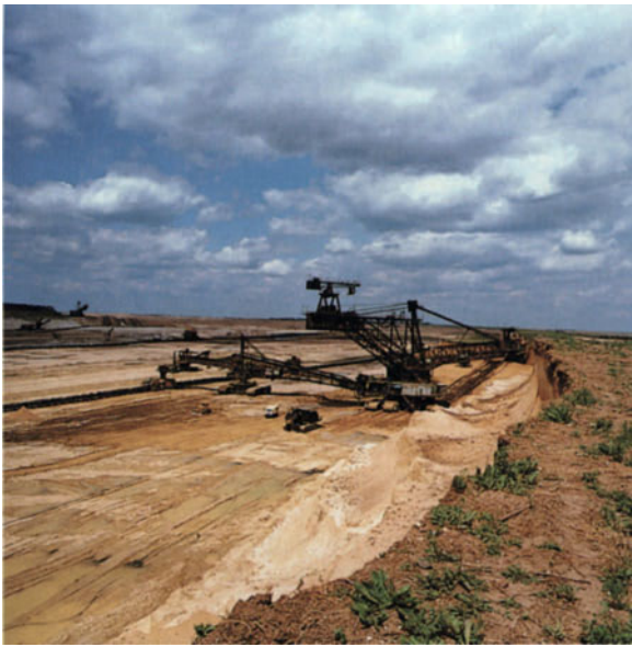
Abb. 2. Selektive Gewinnung von Löß im Bandbetrieb mit Schaufelradbagger (Tagebau Profen-Süd, 1993)
